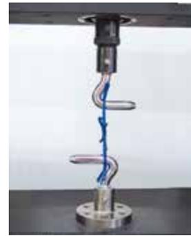
Test d'arrachement suivant la norme européenne
