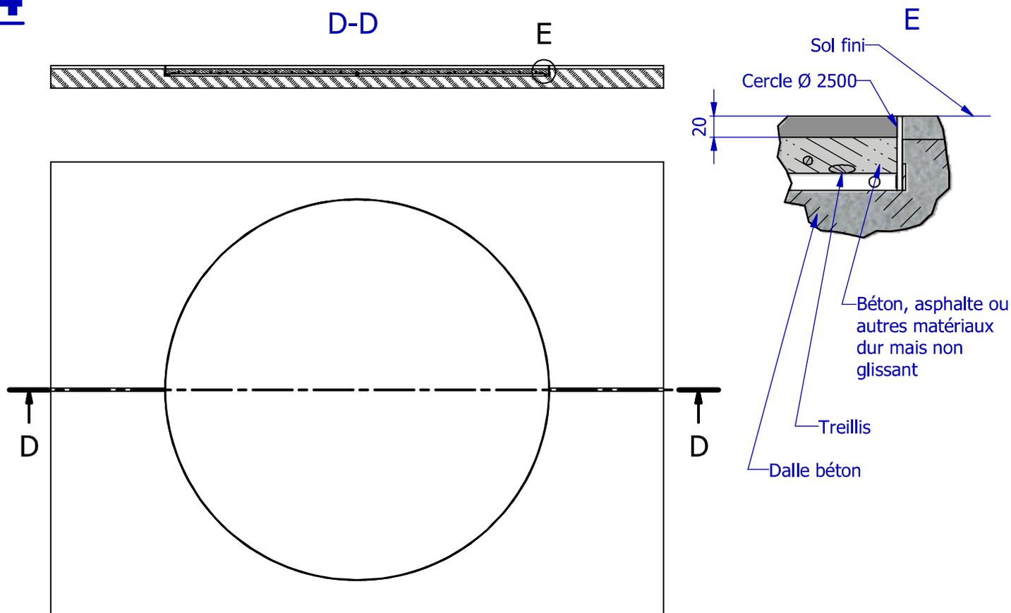
Après mise en place du treillis, procéder au remplissage de l'intérieur du cercle.
