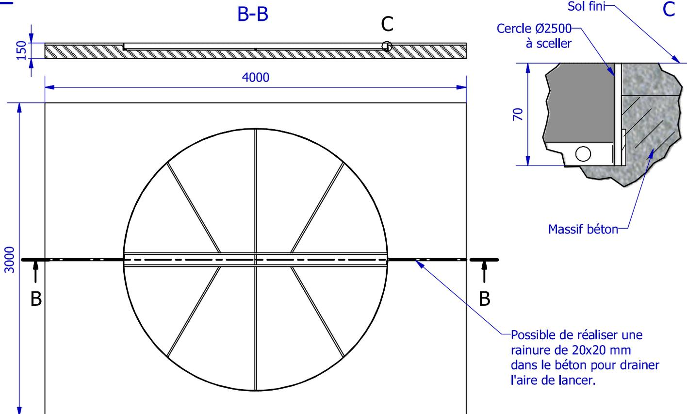
Sceller le cercle dans un massif béton dosé à 350 Kg.
