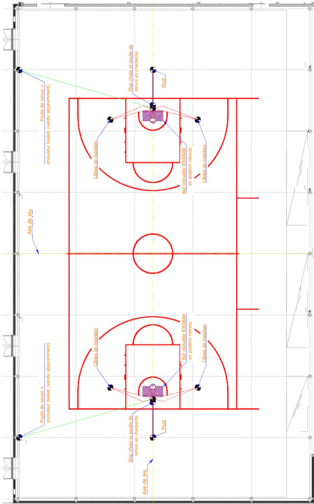
**Les différents efforts des points d'accroche du but sur la charpente (compris renvoi de câbles et système de relevage) sont soumis à la vérification par un BET structure ou un charpentier suivant la norme NFS 52-400. Des renforts ou supports pourront être nécessaires pour l'installation de l'équipement**
