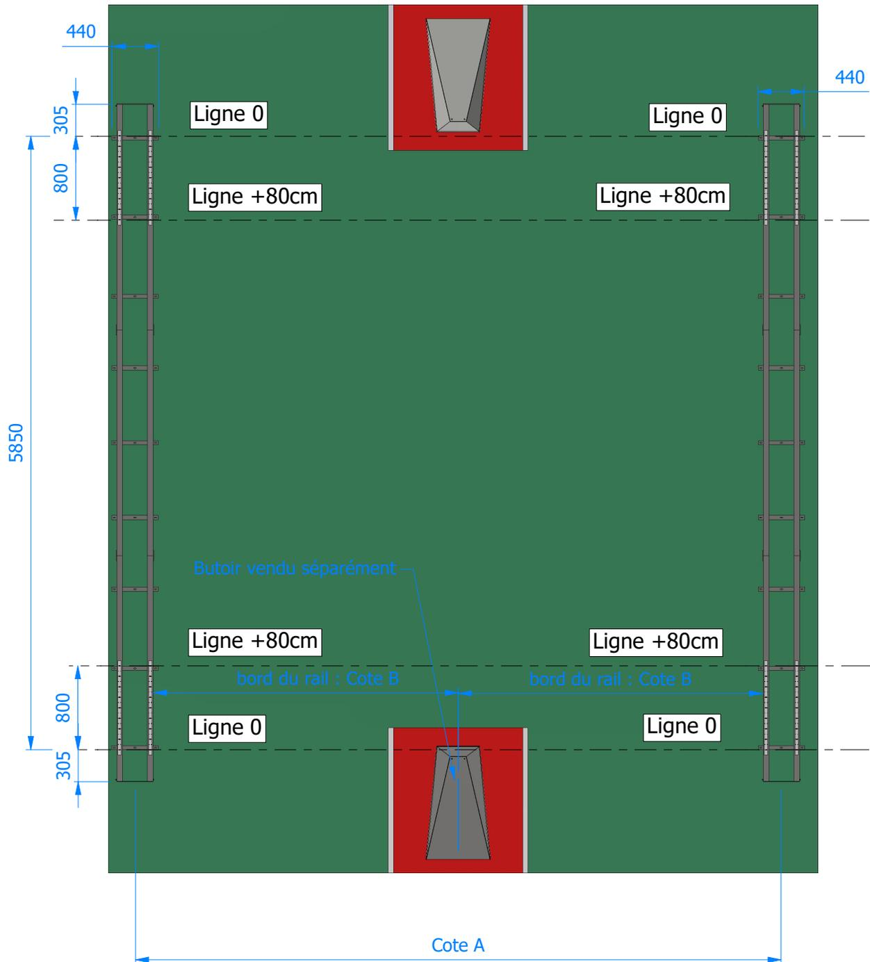
Cote A : Entraxe rail : 6110mm en standard / avec poteaux articulés à l'intérieur d'un abri
