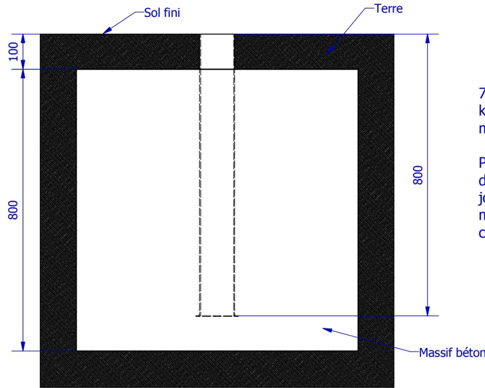
7 massifs béton dosé à 350 kg/m<sup>3</sup>, dimensions 800 x 800 mm, profondeur 800 mm.
