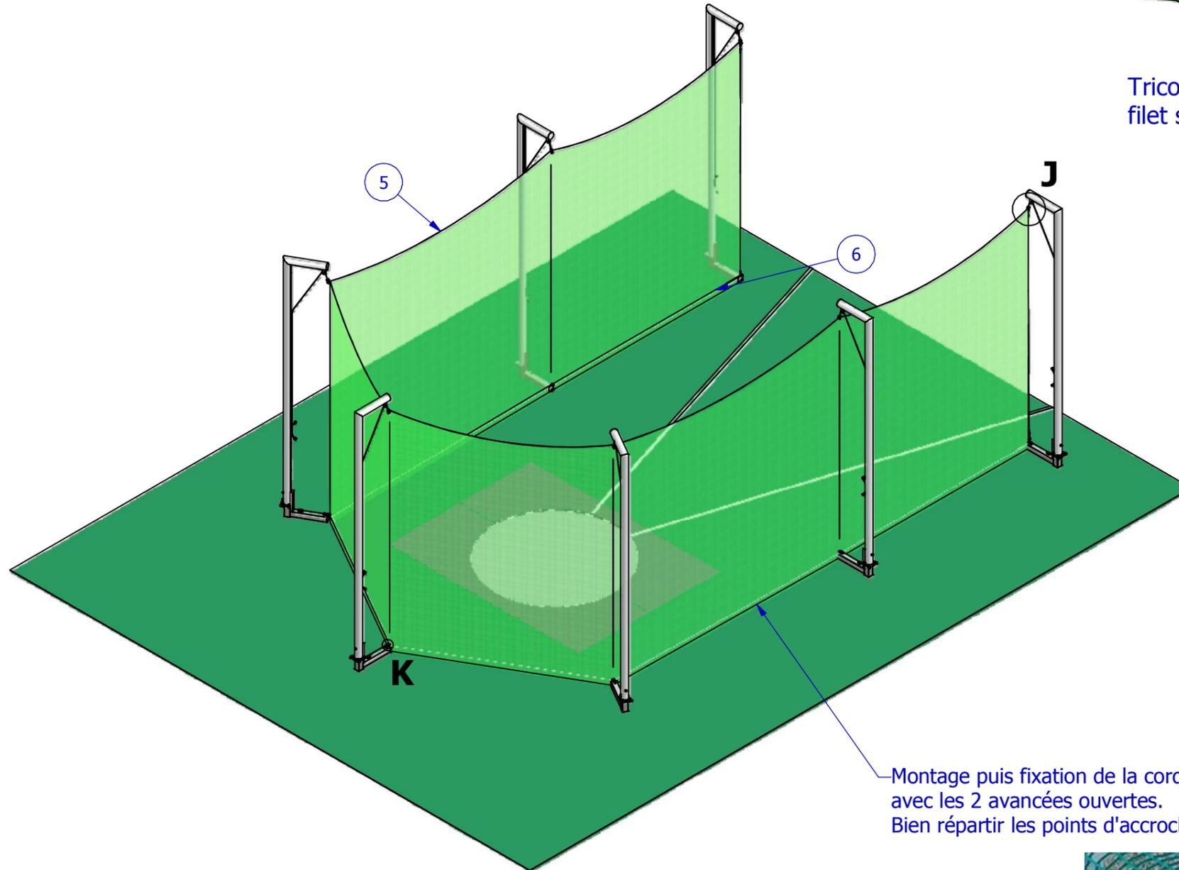
Montage puis fixation de la corde PA blanc avec les 2 avancées ouvertes.
