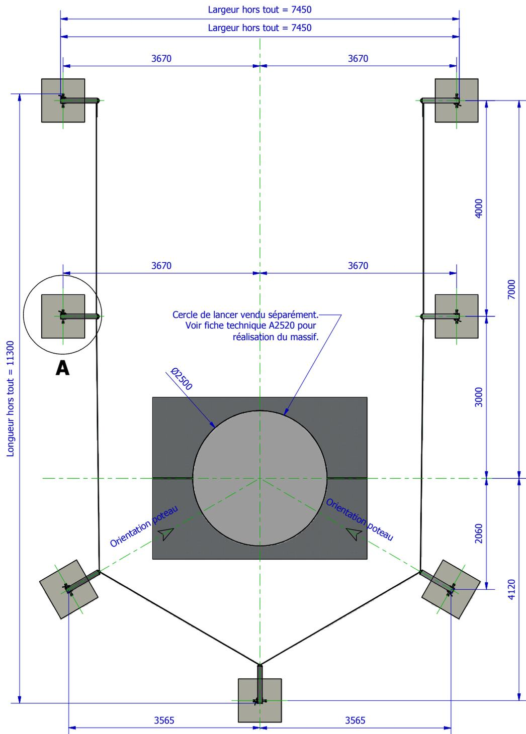
**Cage disque standard****2 : Assemblage des poteaux**
