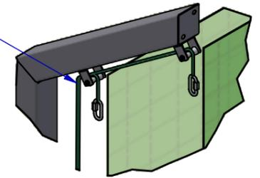
Mise en place des anneaux brisés pour fixer le filet sur le second câble de l'avancée
