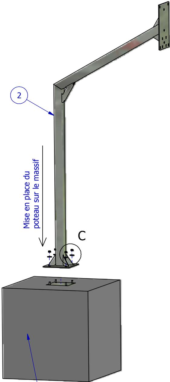
Massif béton à réaliser en premier avec le scellement de la platine 1
