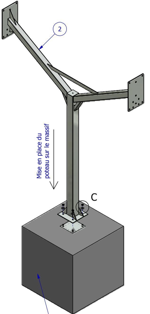
Massif béton à réaliser en premier avec le scellement de la platine 1
