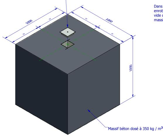
Dans le cas d'une finition enrobé ou enterré, laisser un vide de 150mm du sol fini au massif.
