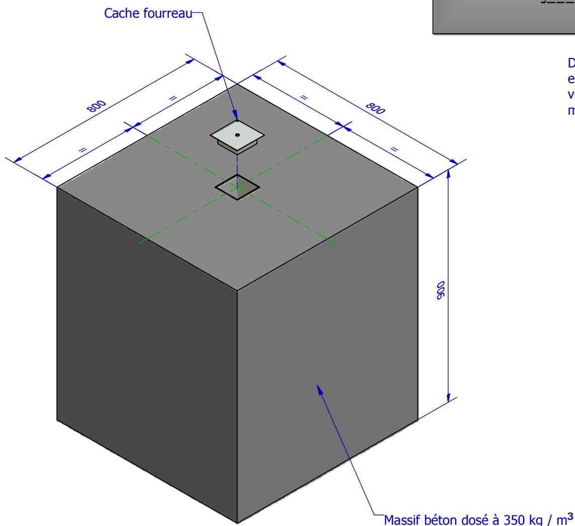
Dans le cas d'une finition enrobé ou enterré, laisser un vide de 150mm du sol fini au massif.
