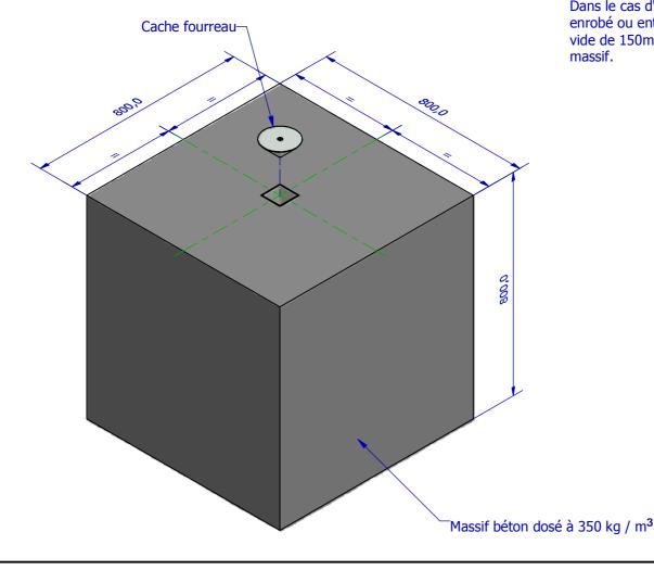
Dans le cas d'une finition enrobé ou enterré, laisser un vide de 150mm du sol fini au massif.
