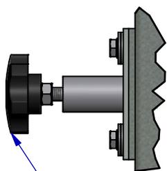
Doigt d'indexage à tirer pour le réglage de la hauteur
