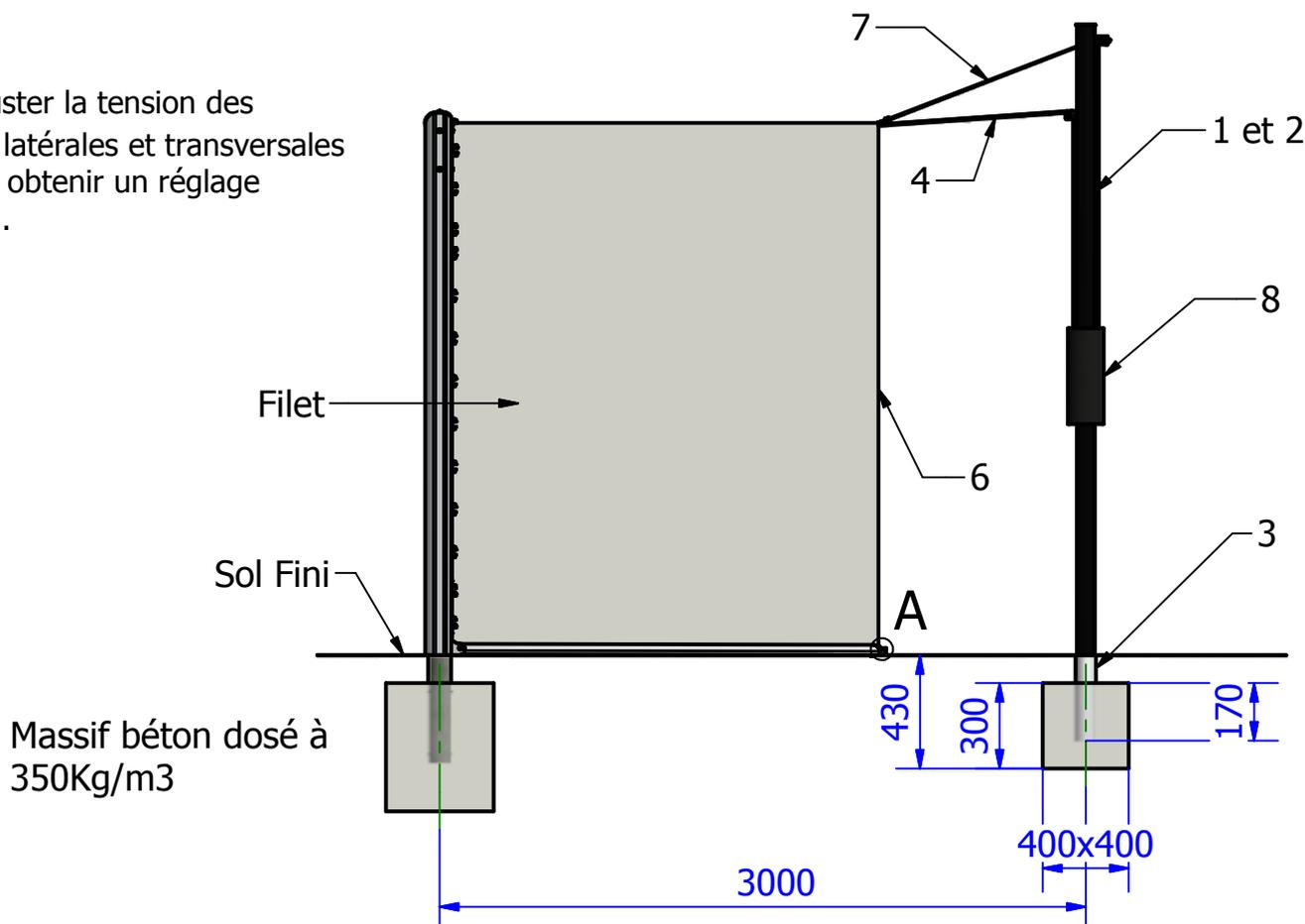
**4:** Fixer fermement la drisse de maintien (6) au coin supérieur du filet puis la faire passer à L'INTERIEUR du filet jusqu'au niveau du lève filet.
