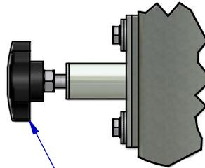
Doigt d'indexage à tirer pour le réglage de la hauteur
