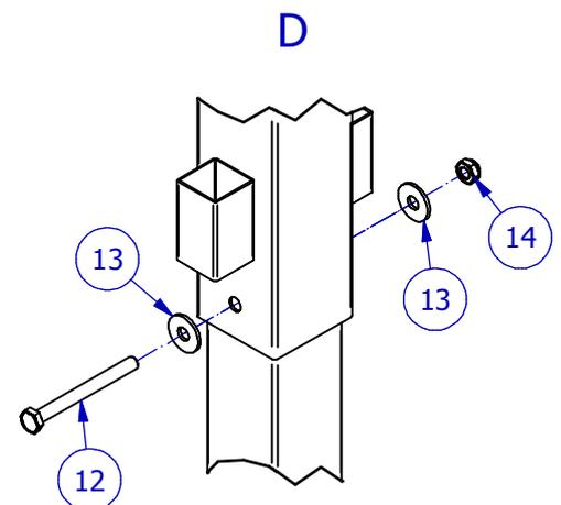
**Couverture de fosse de steeple****3 - Mise en place des barres de cadrage**
