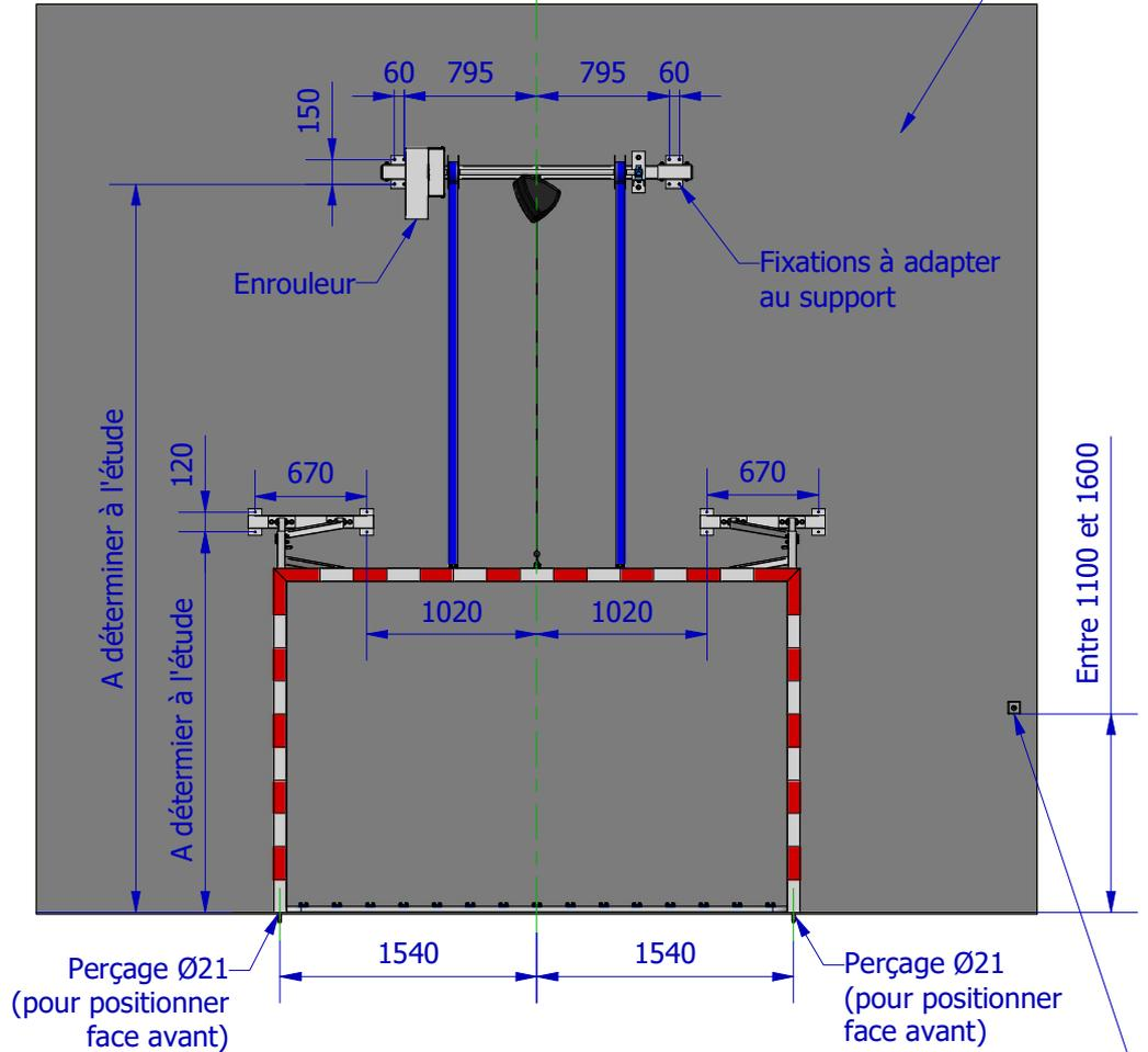
Boitier de commande à installer dans une zone protégée (angles de salle, poteau)
