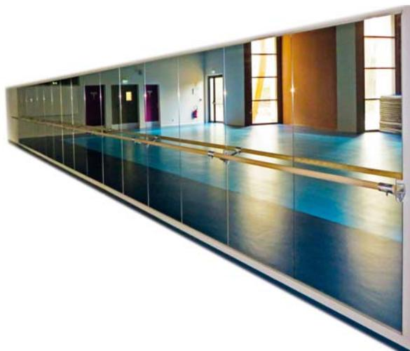
**IMPORTANT : Les miroirs doivent être fixés sur des murs parfaitement plans. Sinon un ragréage ou l'option SUPPORT BOIS peuvent être nécessaires.**
