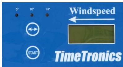
a) En frappant la touche fléchée, vous pouvez régler le temps de mesure de la vitesse du vent. Vous pouvez choisir entre 5, 10 ou 13 secondes. Vous appuyez ensuite sur "Start" pour commencer la mesure du vent. La vitesse moyenne du vent apparaît à l'écran du boîtier de mesure lorsque le temps réglé est écoulé. Par exemple:
