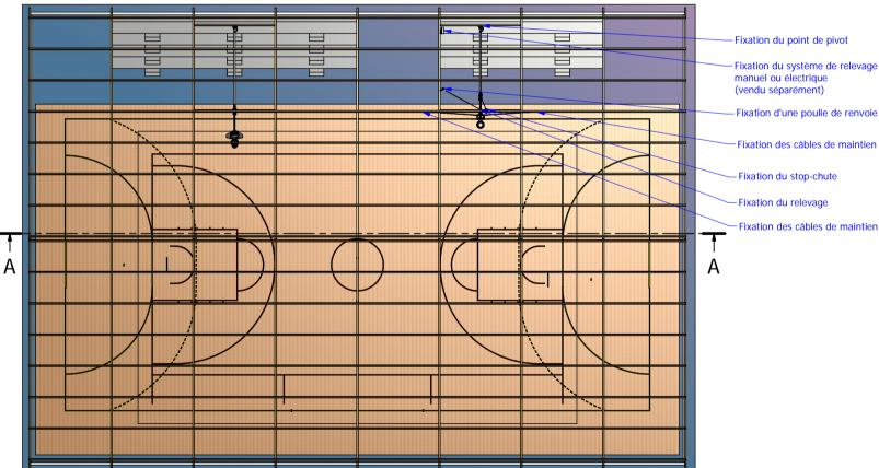
Les différents efforts des points d'accroches du but sur la charpente (compris renvois de câbles et système de relevage) sont soumis à la vérification par un BET structure ou un charpentier suivant la norme NFS 52-400. Des renforts ou supports pourront être nécessaires suivant l'implantation à réaliser.
