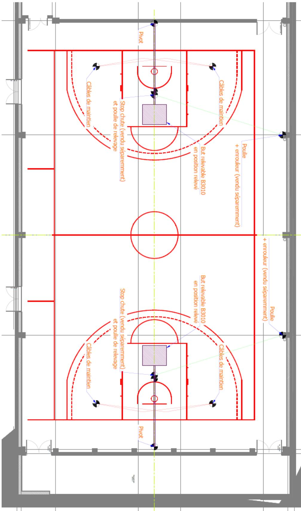
**Les différents efforts des points d'accroche du but sur la charpente (compris renvoie de câbles et système de relevage) sont soumis à la vérification par un BET structure ou un charpentier suivant la norme NFS 52-400. Des renforts ou supports pourront être nécessaire pour l'installation de l'équipement**
