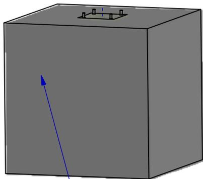
Massif béton à réaliser en premier
