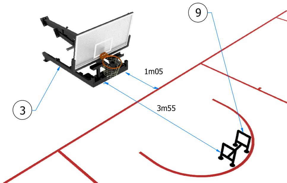
Placer le socle (3) à 1m05 de la ligne de touche extérieure et le banc (9) à 3m55 du socle (2m50 de la ligne extérieure)
