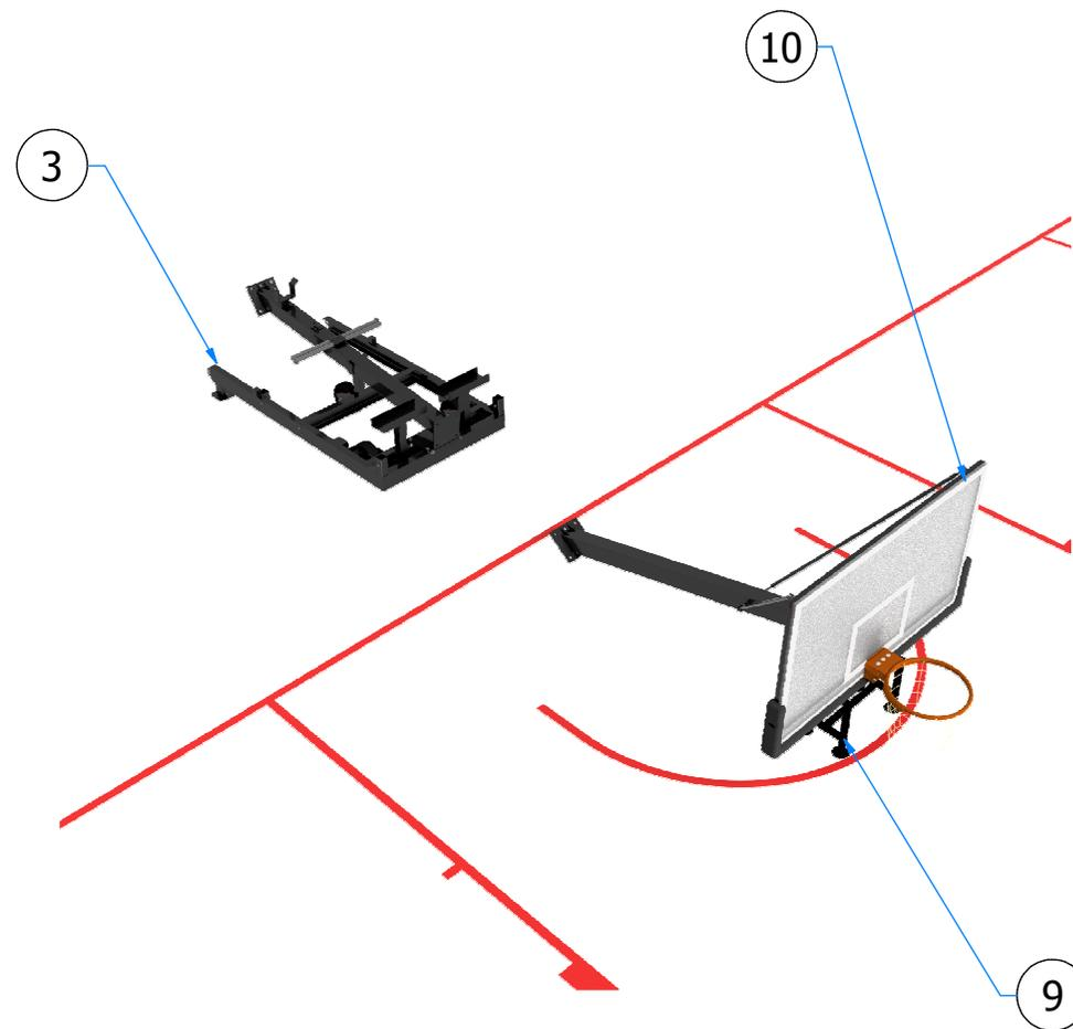
Poser le panneau (10) sur le banc (9) dans l'axe du socle (3).
