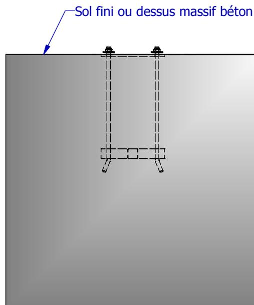
Dans le cas d'une finition enrobé ou enterré, laisser un vide de 150mm du sol fini au massif.
