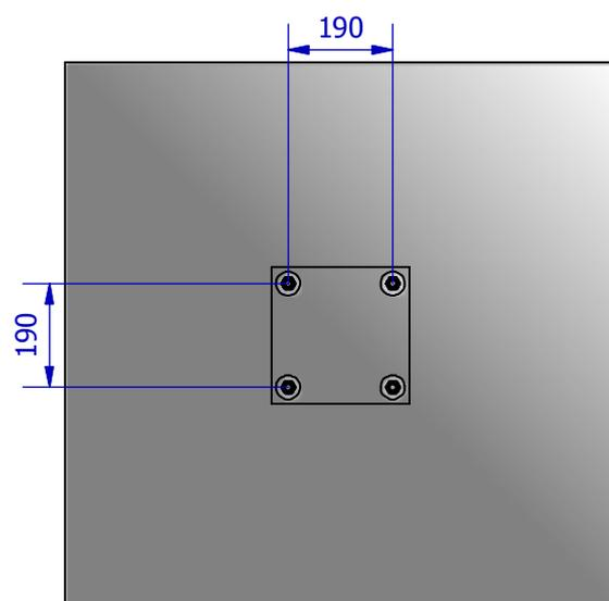
Massif béton dosé à 350 kg / m<sup>3</sup>
